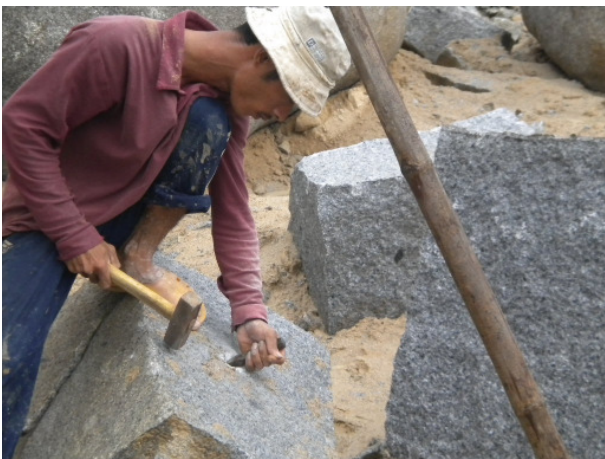
Mit dem Meißel Löcher schlagen und mit Keilen den Stein teilen, erfordert Geschick und Erfahrung. Making holes with a chisel and splitting stones with splines require a lot of experience and skills.
