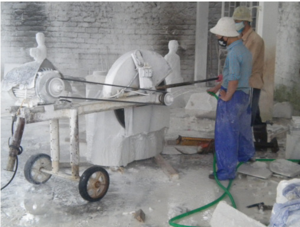
Kleine, ungesicherte Steinsäge, aber Mundschutz. Small, unsecured stone saw, but mask.
