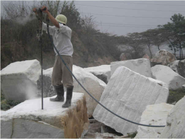
Bohren von Marmor im Freien mit Staubmaske. Outside drilling of marble using dust masks.
