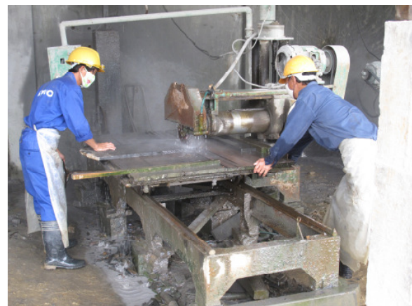
Korrektter Arbeitsplatz aber Verzicht auf Hörschutz. Accurate workplace but neglect of ear-protection.
