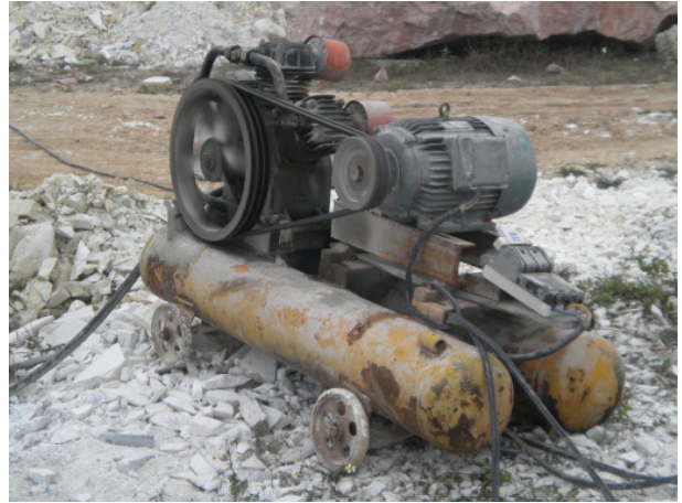
Pressluft für Bohrer: Keilriemenschutz fehlt, abenteuerlicher Stromanschluss. Compressed air for drills: v-belt guard is missing, adventurous electrical connection.
