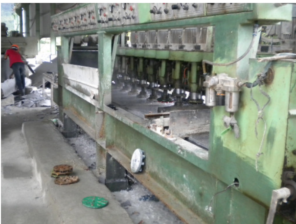
Poliermaschine für Natursteine. Polishing machine for natural stones.
