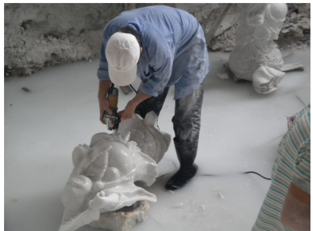
Dünne Wasserschläuche verhindern Staubentwicklung. Thin water tubes prevent dust from emerging.
