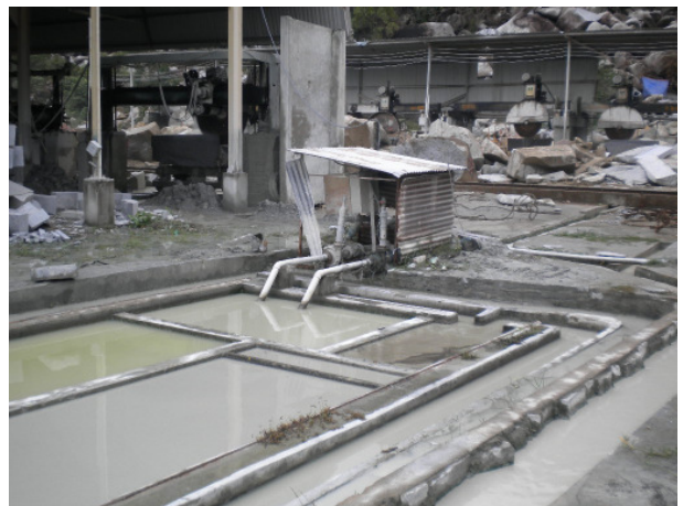
Kein Steinwerk ohne Kläranlage. No stone factory without filter plant.
